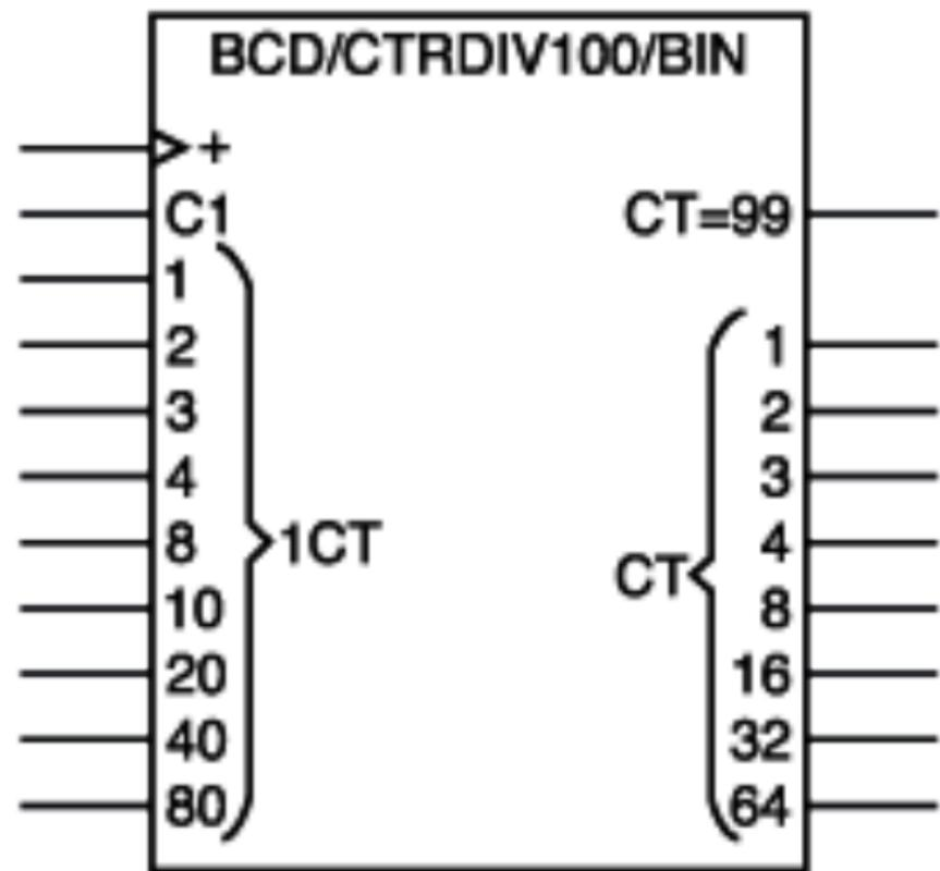
Compteur, divisant par 100, avec entrées en code BCD et sorties en code binaire
