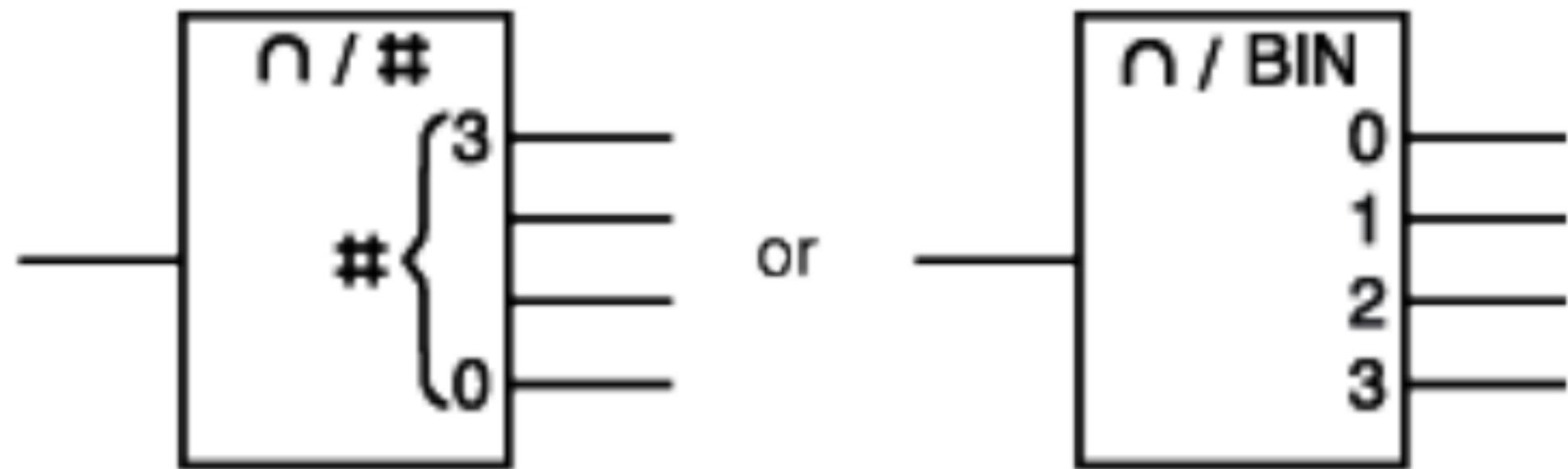
Convertisseur analogique-mérique transformant le signal analogique d'entrée en un code numérique pondéré à quatre éléments binaires
